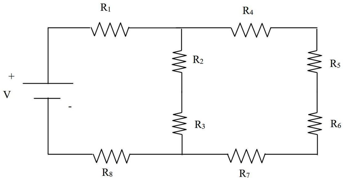
$V=23\text{V}$ ;  $R_1=3.30\text{ohms}$ ;  $R_2=9.90\text{ohms}$ ;  $R_3=6.60\text{ohms}$ ;  $R_4=2.10\text{ohms}$ ;  $R_5=1.90\text{ohms}$ ;  $R_6=4.90\text{ohms}$ ;  $R_7=5.70\text{ohms}$ ;  $R_8=6.50\text{ohms}$ .
